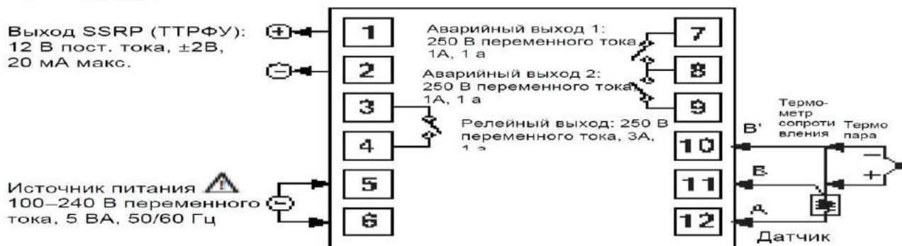
Рис. 9. Электрическая схема температурного контроллера.
